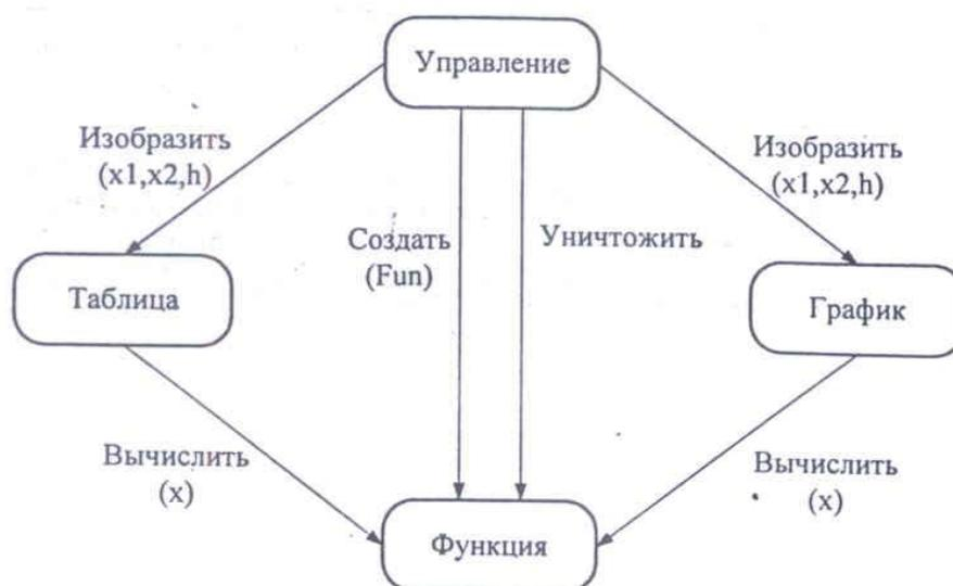
Рис. 6.1. Объектная декомпозиция программы построения таблиц и графиков
