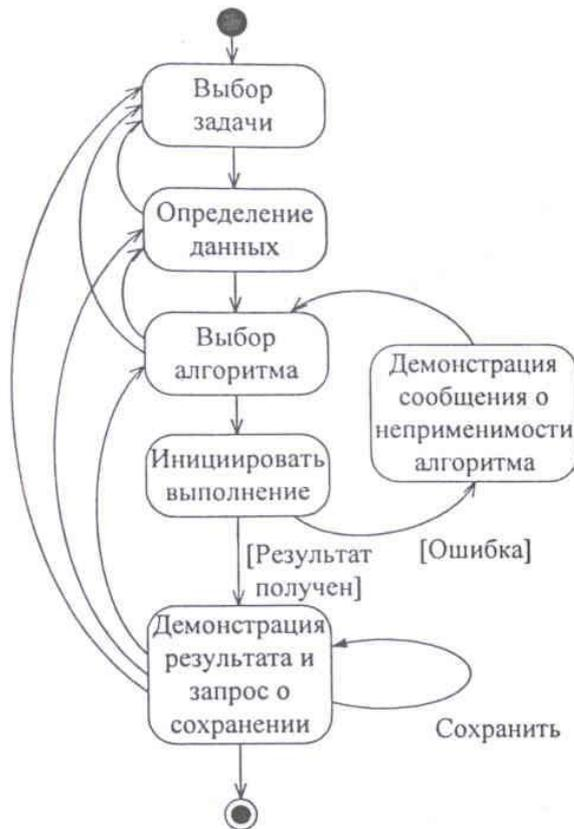
Рис. 8.13. Граф абстрактного диалога комбинированного типа
