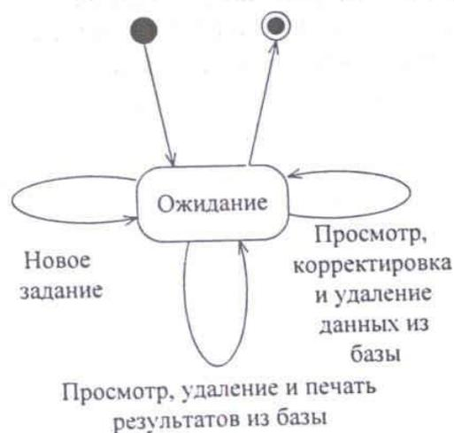
**Рис. 8.11.** Граф абстрактного диалога системы решения комбинаторно-оптимизационных задач
