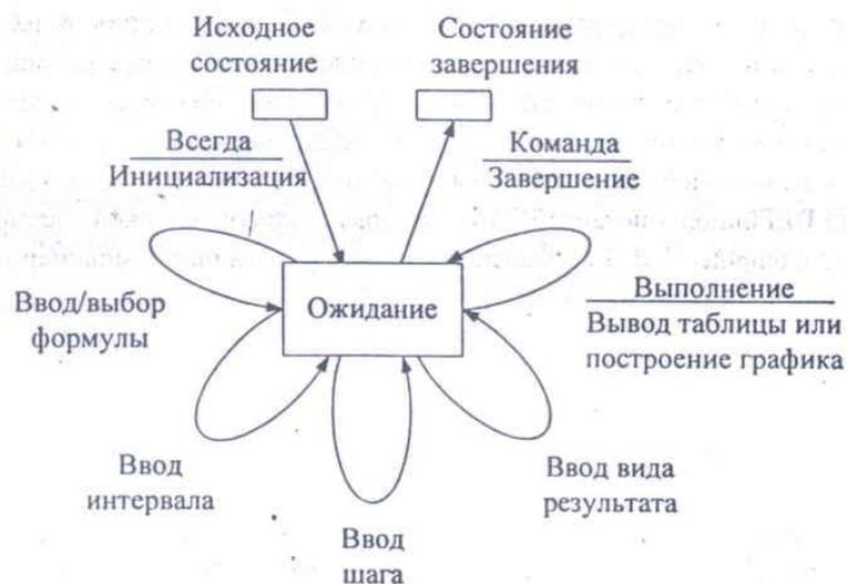
Рис. 4.6. Диаграмма переходов состояний программы построения графиков/таблиц функций
