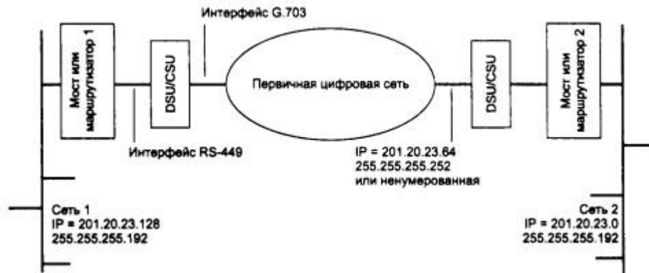
Рис. 6.14. Соединение сетей с помощью выделенного канала
