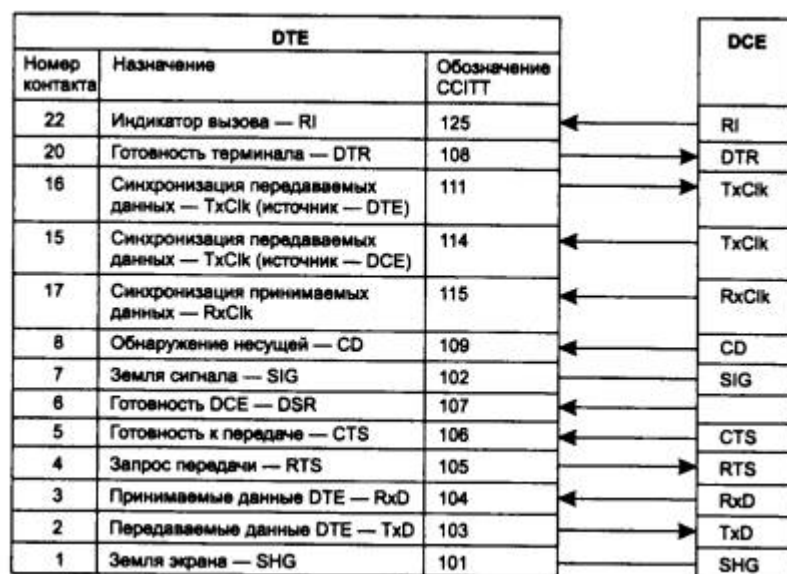
Рис. 6.3. Сигналы интерфейса RS-232C/ V.24
