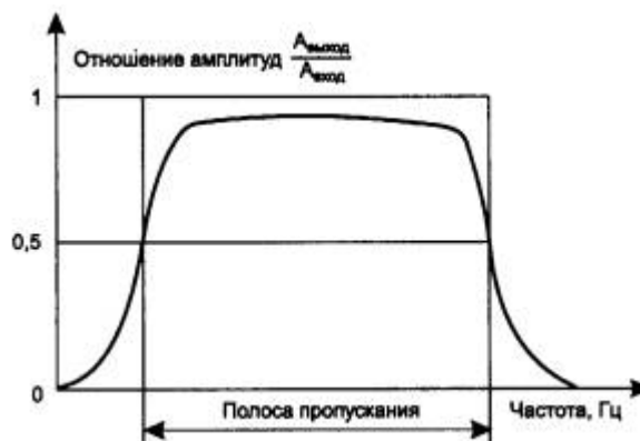
Рис. 2.7. Амплитудно-частотная характеристика
