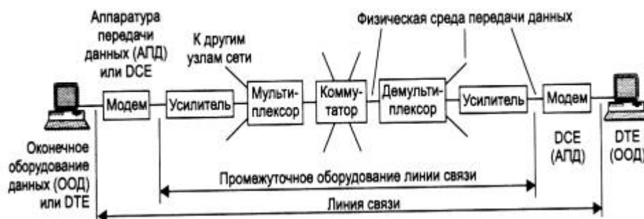
Рис. 2.1. Состав линии связи
