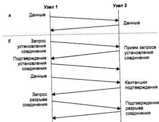
Рис. 2.23. Протоколы без установления соединения (а) и с установлением соединения (б)
