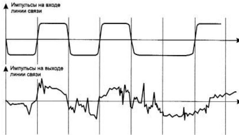
Рис.2.5. Искажение импульсов в линии связи
