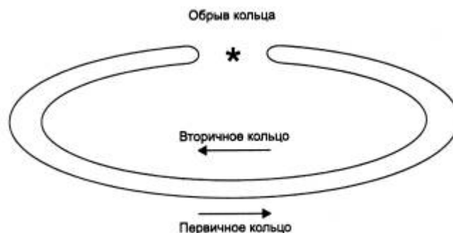
Рис. 3.16. Реконфигурация колец FDDI при отказе
