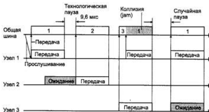
Рис. 3.3. Метод случайного доступа CSMA/CD
