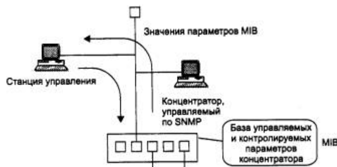
Рис. 4.11. Структура системы управления на основе протокола SNMP
