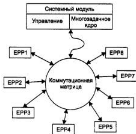
Рис. 4.23. Структура коммутатора EtherSwitch компании Kalpana
